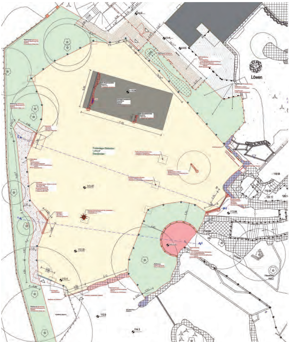
Abb. 27: Eine detaillierte Darstellung des Erweiterungsteils. Als roter Halbkreis ist die künftige Besucherplattform zu erkennen. Sand wird als Substrat für den größten Teil der Anlage genutzt werden. Als dunkles Rechteck zu erkennen ist eine bereits vorhandene Betonfläche, die künftig als weitere Futterstelle für die Elefanten dienen soll. Auf dieser Fläche waren die drei Boxen in der Interimshalle untergebracht. Quelle: Zoo Dresden & HJW Partner
